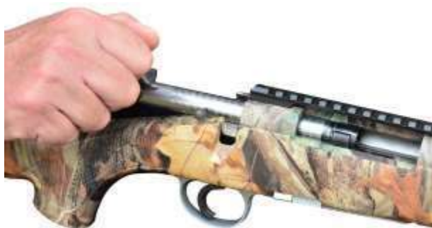
L'otturatore in fase di apertura
