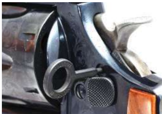
Sicura a chiave di un revolver
