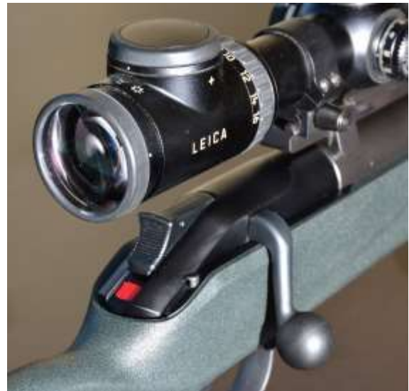
Una carabina dotata di pulsante disarmo del percussore. Un vistoso elemento rosso avvisa che il percussore è armato
