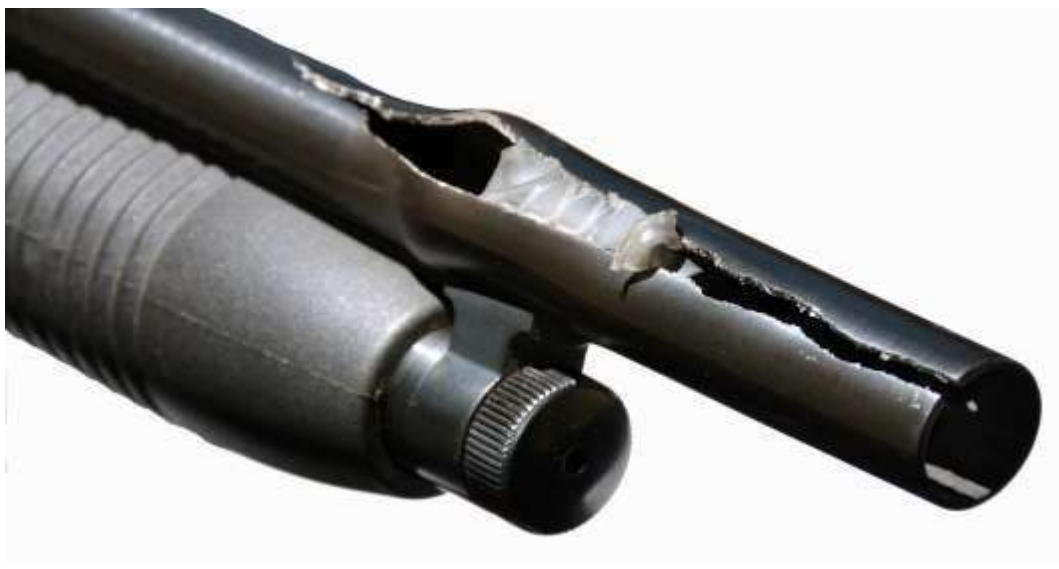
Fucile calibro 12. Il picco delle pressioni, dovuto a ostruzione, ha causato rigonfiamento e fessurazione della canna in prossimità della volata
