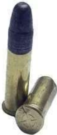
Cartucce calibro .22LR, notare l'impronta del percussore sul bordo del fondello
