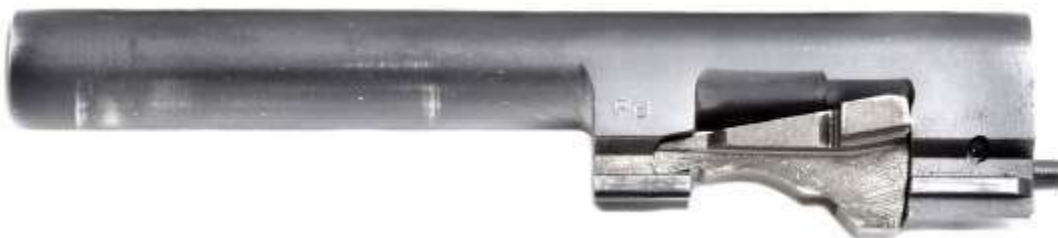
La canna di una pistola Beretta serie 92/98 dotata di blocchetto oscillante. Il sistema Walther prevede che la canna possa solamente arretrare sul suo asse, lasciando al blocchetto il compito di oscillare verso il basso
