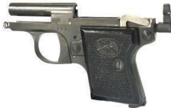
La pistola Bernardelli, mod. Baby, dotata di chiusura a massa in smontaggio ordinario. Si nota la canna ancorata al fusto
