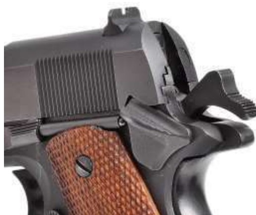
Una pistola Colt mod. 1911 con sicura inserita e cane armato. Il grilletto è bloccato, l'arma è "cocked and locked"
