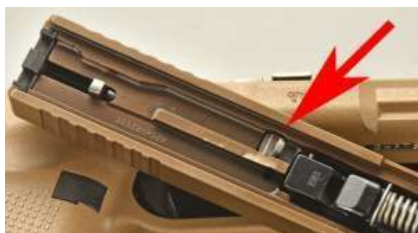
La freccia indica la provvidenziale sicura automatica al percussore collocata all'interno del carrello
